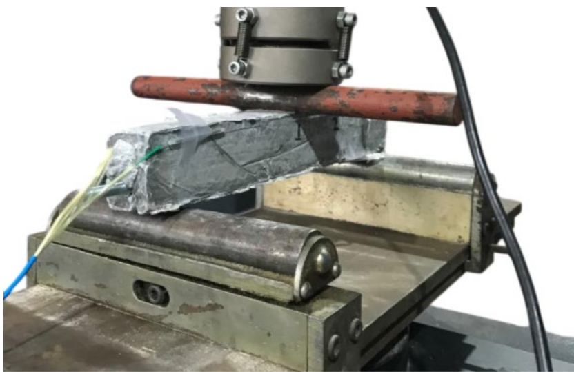
1.12-сурет – Бетонға енгізілген сенсорға иілу деформациясының әсерін көрсету сынағы
