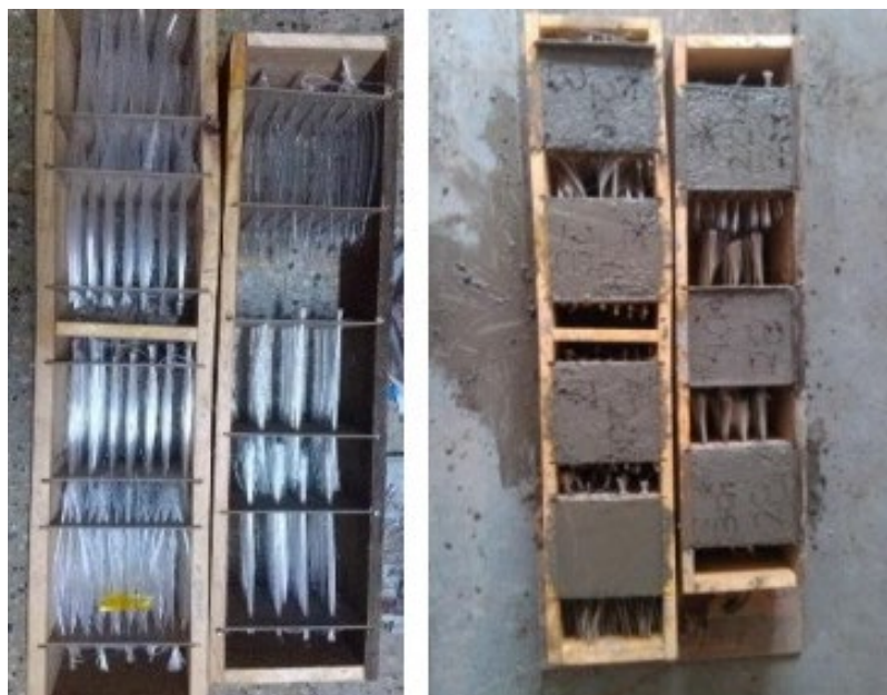
2.8-сурет – Бетон ерітіндісінің құйылу кезінде ТОС енгізу тәжірибесі
