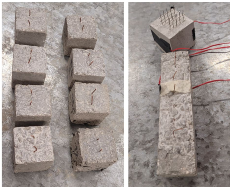
1.14-сурет – Көміртекті талшықтар қосылған бетон үлгілері
