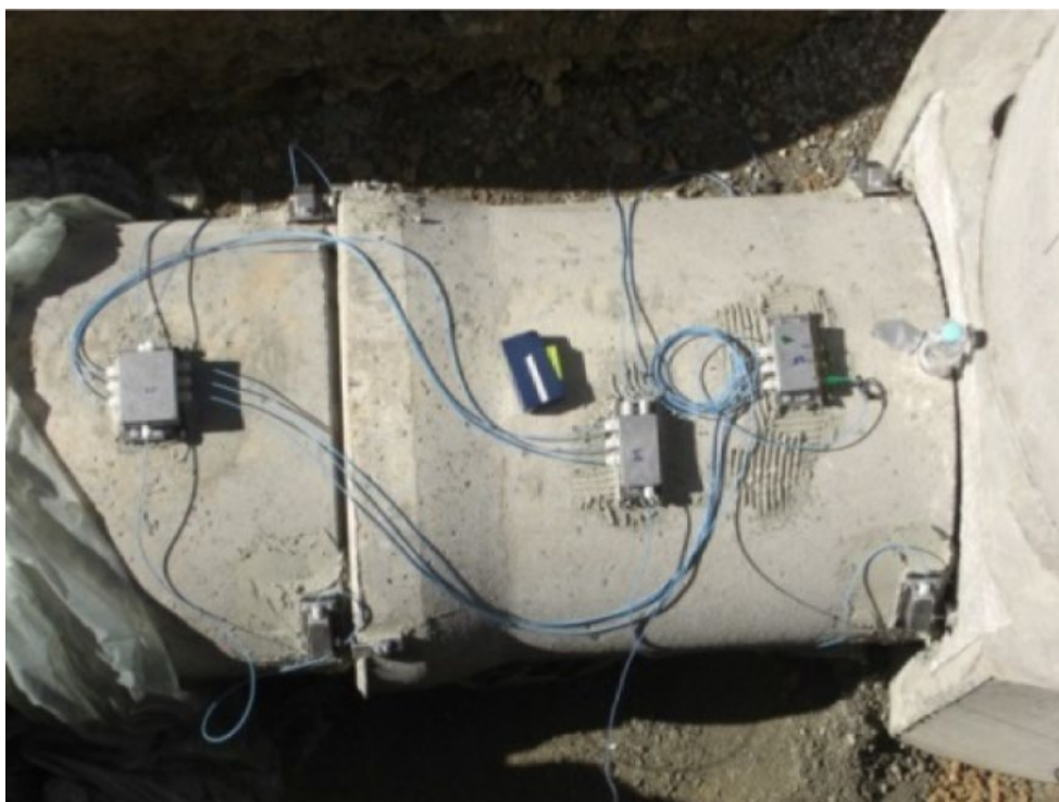
2.13-сурет – Тоқымалы FBG сенсорының құрылыс нысандарындағы көрінісі
