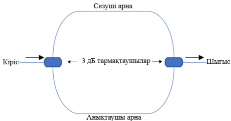
1.8-сурет – Мах-Зендер интерферометриялық сенсорының құрылымдық сұлбасы
